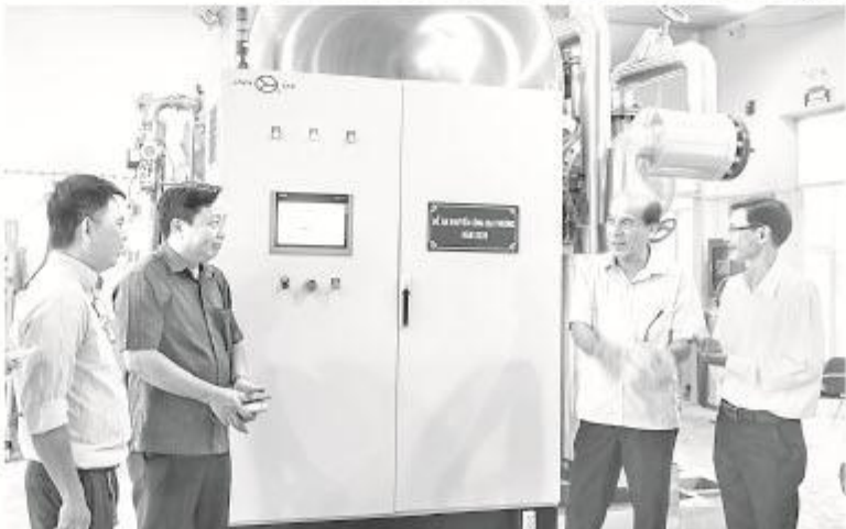
Máy cô đặc và tiệt trùng chân không liên tục tự động, với công suất 500 lít/giờ có tích hợp bơm nhiệt để cô đặc mật hoa dừa.
